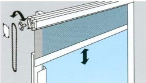
Im Objektbau werden spezielle Anforderungen gestellt, die das Kassetten-Blendschutzrollo ideal erfüllt. Eine seitliche Führung des Rollos macht das Fenster wirklich dicht. Eine zusätzliche seitliche Lichtschutzbürste verhindert den Einfall von Restlicht, unabdingbar für Bildschirmarbeitsplätze.
